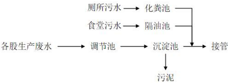
图 4-1 废水治理工艺流程和监测点位图
