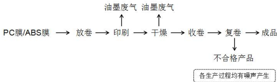
图 3-5 生产工艺流程及产污环节图
