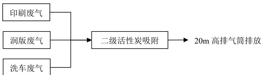
图 4-2 废气治理工艺流程图
