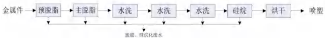
图 3-6 脱脂、硅烷化处理工艺流程及产物环节图
