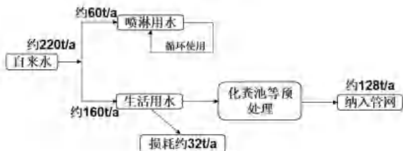
图 3-3 水量平衡图 (t/a)
