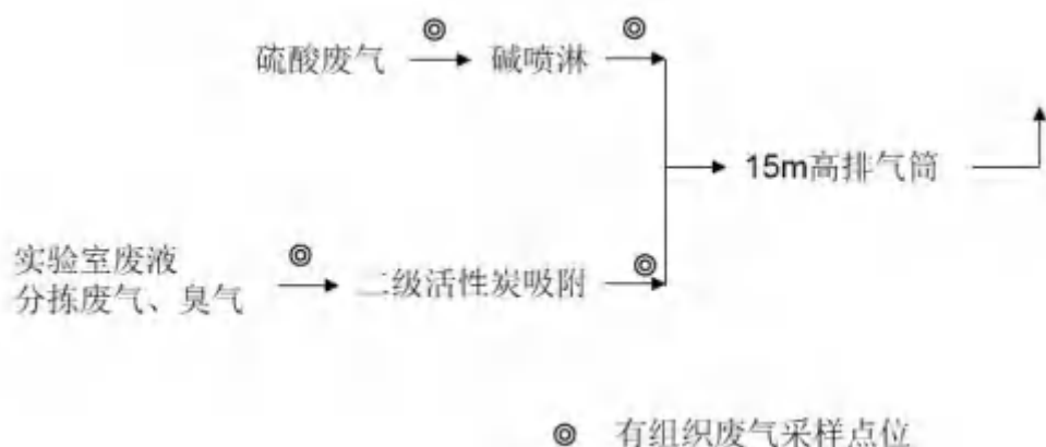
图 4-2 废气治理工艺流程及监测点位图
