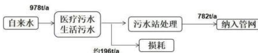
图 3-3 水量平衡图
